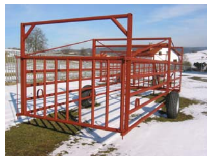
Hinteres Tor lässt sich nach beiden Seiten um 270° öffnen
