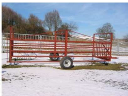
Seitenwände 5 Rohre 2" mit 3.65mm Wandstärke
